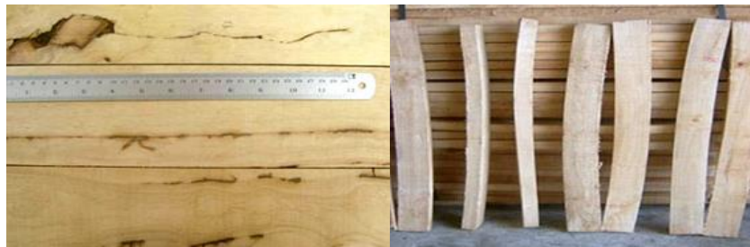
รอยตำหนิที่เกิดขึ้นจากการ กริดยางของไม้ยางพารา
